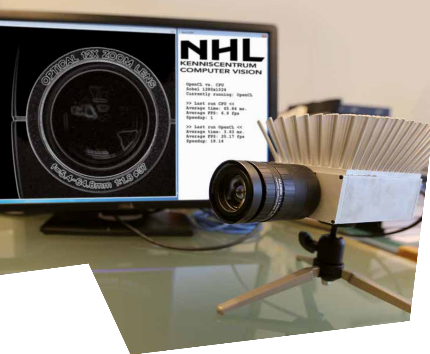
Afbeelding 5 Prototype intelligente camera met multi-core CPU en GPU, beschikbaar gesteld door de Duitse fabrikant
